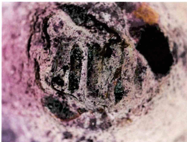
Pohled na obnaženou předpínací výztuž s použitím pH indikátoru
